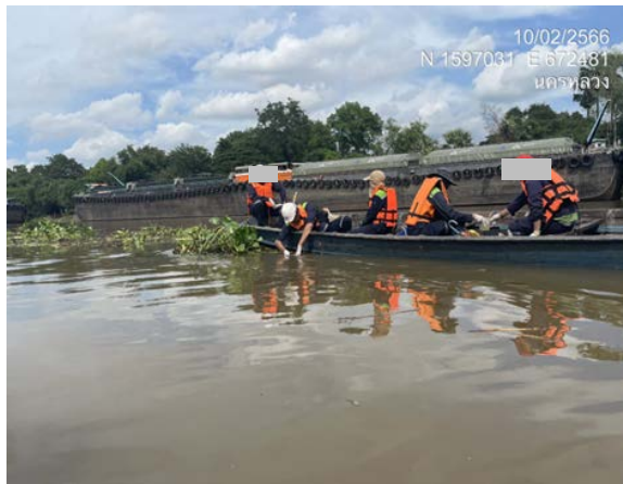
การเก็บตัวอย่างน้ำผิวดินสำหรับวิเคราะห์ DO ด้วยเครื่องเก็บตัวอย่างน้ำแนวตั้งและขวดแก้ว
